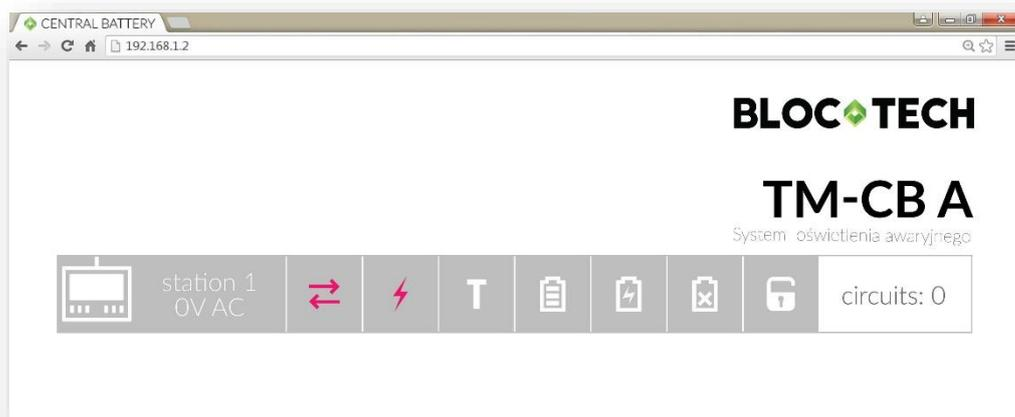
Après avoir réussi la configuration de la connexion réseau et entré l'adresse IP définie/reçue dans le navigateur Web, un site Web doit être affiché. Le site Web permet de prévisualiser rapidement l'état du système.
