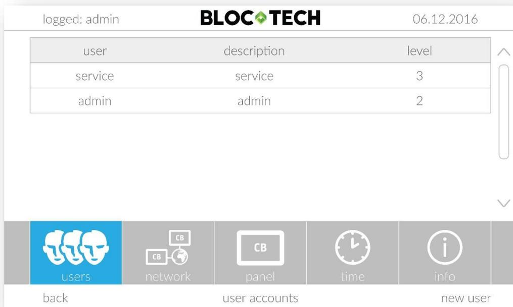
Le menu contient une liste d’utilisateurs ajoutés au système. Le système permet d’ajouter 250 utilisateurs. L’élément de la liste se compose des éléments suivants :
